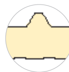
Utvändigt trapetsprofilerad, invändigt profilerad
