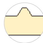
Utvändigt trapetsprofilerad, invändigt plan
